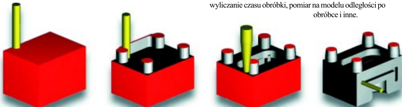
Kilka faz wizualizacji procesu obróbki w module Tape-To-Part .
