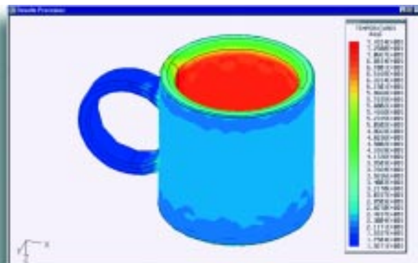
Rys. 13 Rozkład temperatury w kubku z herbatą
