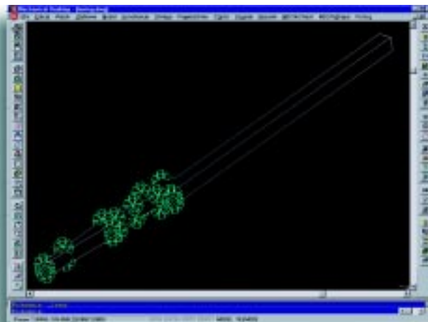
Rys. 8 Zamocowanie modelu do analizy drgań własnych
