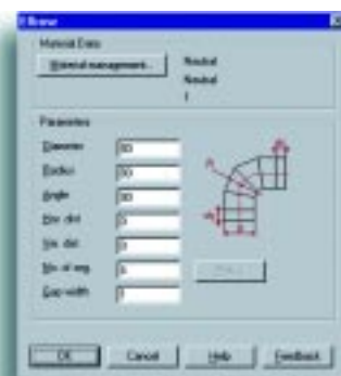
Rys. 4. Parametry opisujące element biblioteczny – kolanko
