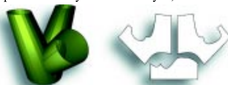
Rys. 5. Model trójwymiarowy połączenia oraz rozwinięcia jego poszczególnych części
